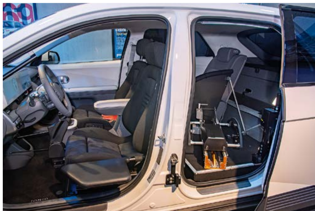
Komfortabler Einstieg mit elektrisch höhenverstellbarem Rutschbrett, Rollstuhlverladesystem hinter dem Fahrersitz.
